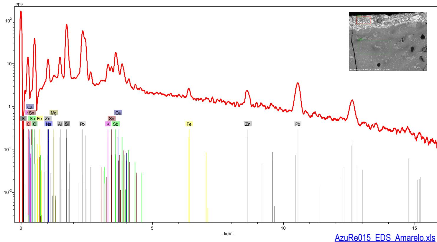
Equipamento: Microscópio eletrónico de varrimento HITACHI 3700N acoplado a um espectrómetro de energia dispersiva de raios-X Bruker Xflash 5010.
